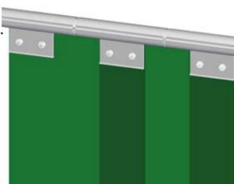
6 Bei einer Überlappung von 5 cm (33%) lassen Sie bitte jeweils 1 Loch frei und setzen Sie zur Ausfüllung ein Distanzstücke ein.
