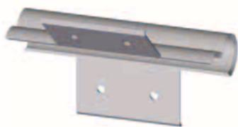
2 Drücken Sie die Pendelschale über das Rohr.
