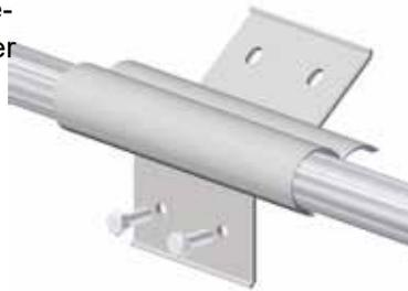
4 Jetzt können die Lamellen überlappend aufgehängt werden. Bei einer Überlappung von 10 cm (66%) überlappen jeweils beide Löcher.
